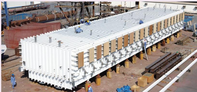
沙特阿拉伯在建的多级闪急蒸馏法淡化海水装置
